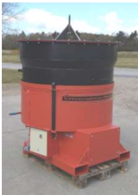
TE500 med 11 kW motor, forstærket blandemølle, og højt låg med store knive for big bags ←
