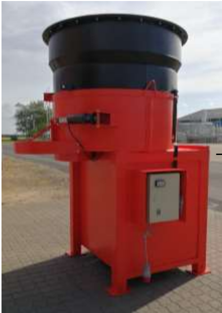
TE500 til Grout mix. Bygget på stålskelet, monteret med forstærket blandemølle, højt låg med store knive for big bags og aktuator for åbning af tømmelege
