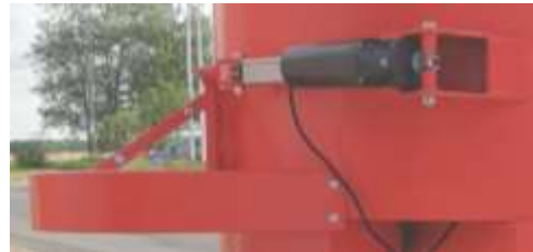
TE500 til Grout mix. Bygget på stålskelet, monteret med forstærket blandemølle, højt låg med store knive for big bags og aktuator for åbning af tømmelege
