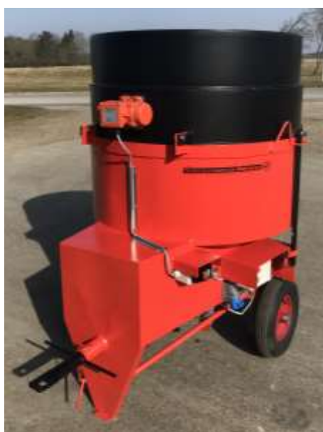
TE300 med højt låg og vibrationsmotor for hurtigere blanding ←
